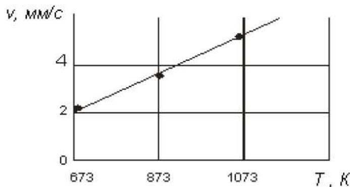
Рис.2 . Зависимость скорости горения от начальной температуры
