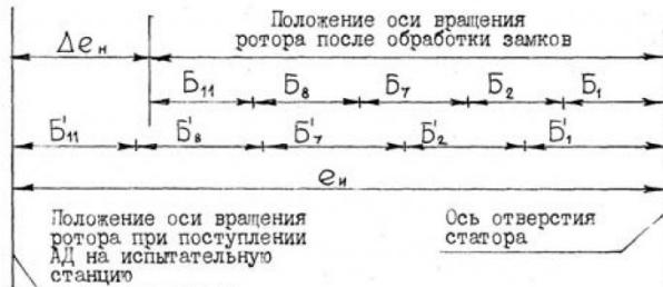
Рис. 2. Расчетная схема для определения увеличения эксцентрикситета оси вращения ротора из-за нестабильности во времени размеров корпусных деталей АД:  $B_1, B_2, B_7, B_8, B_{11}$  – составляющие звенья размерной цепи эксцентрикситета  $e_{ob}$ ;  $B'_1, B'_2, B'_7, B'_8, B'_{11}$  – соответствующие звенья размерной цепи эксцентрикситета  $e_u$
