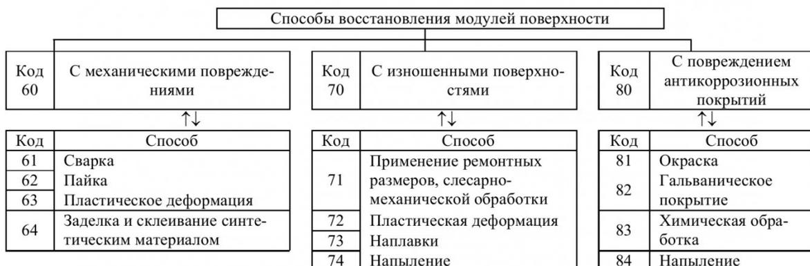
Рис. 3. Классификатор способов восстановления модулей поверхностей
