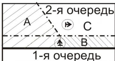
Рис.4. Схема очередности отработки карьерного поля с выделением технологических частей
