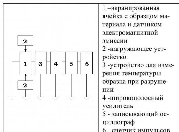
Рис 1. Блок-схема лабораторной установки для изучения разрушения образцов методом ЭМИ
