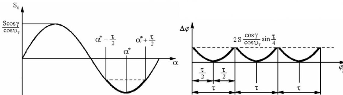
Рис. 3. Кинематическая погрешность глобоидной передачи
