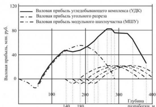
Рис. 1. Зависимость валовой прибыли УДК от последовательно-параллельной структуры ведения горных работ угольного разреза и модульных шахтоучастков
