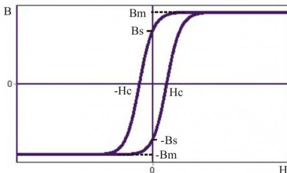
Рис. 1. Петля гистерезиса, соответствующая предельному циклу
