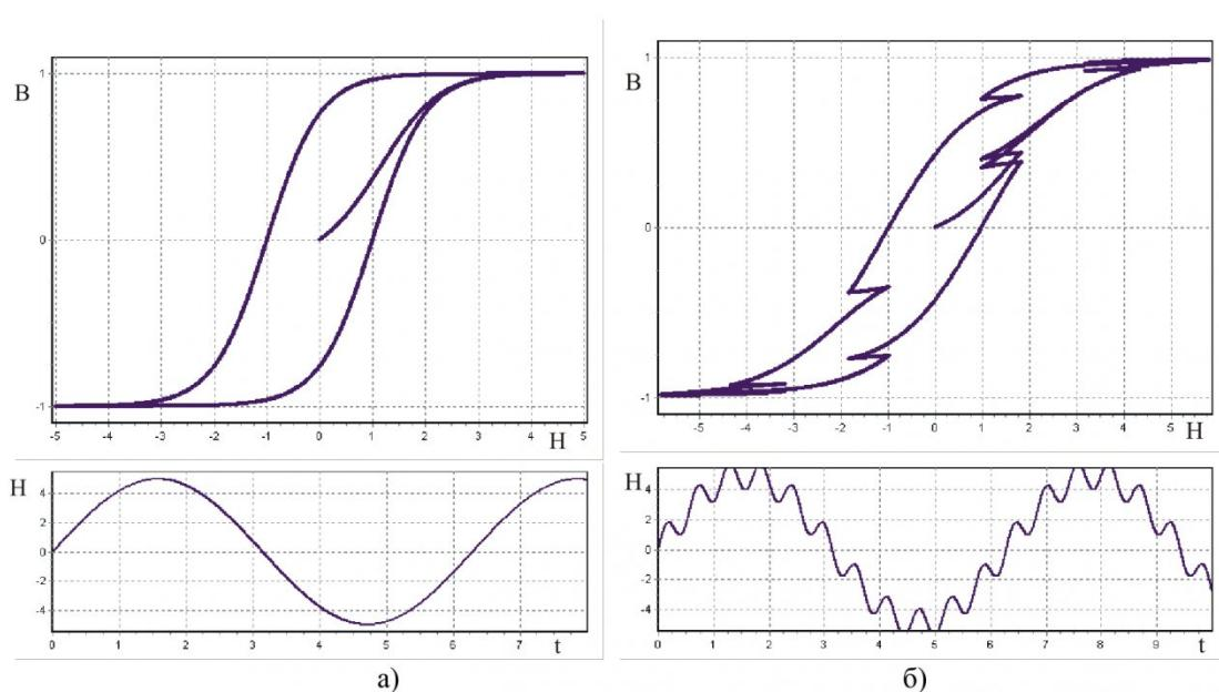
Рис. 2. Характеристики динамического гистерезиса: а) при синусоидальном изменении напряженности магнитного поля; б) при несинусоидальном изменении напряженности магнитного поля
