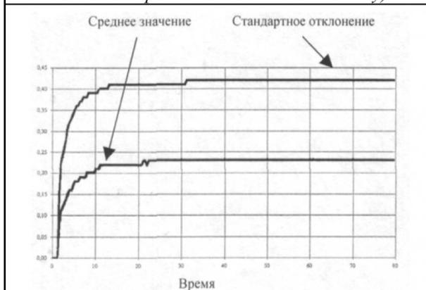
Рис. 6. Относительное время пребывания комбайна в состоянии  $E_4$  (комбайн работает с номинальной нагрузкой)
