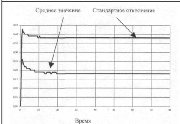
Рис. 4. Относительное время пребывания комбайна в состоянии  $E_2$  (двигатели нижнего и верхнего шнека работают на холостом ходу)
