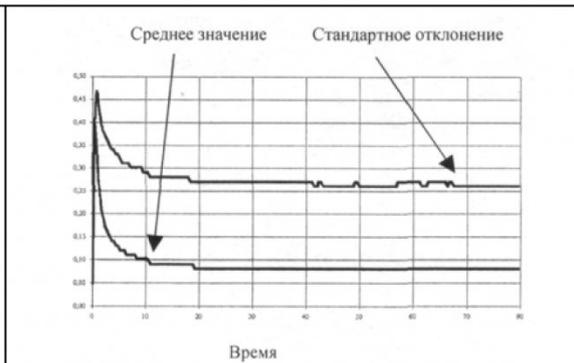
Рис. 3. Относительное время пребывания комбайна в состоянии  $E_1$  (двигатель нижнего шнека работает на холостом ходу)
