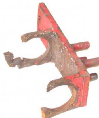
*Рис. 2. Подшипниковые опоры устройства РП-2К, поврежденные при посадке гидростойки-стойки на жестко*
