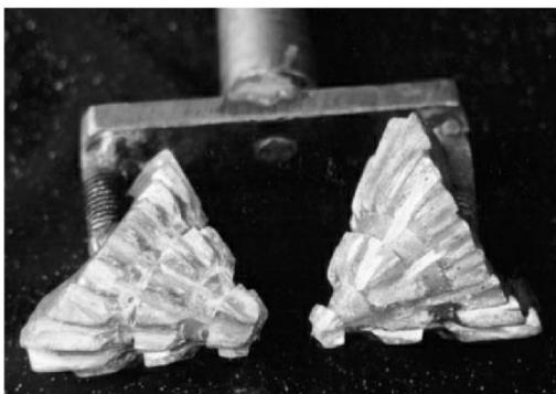
Рис. 1 Опытный образец двухшарошечного долота
