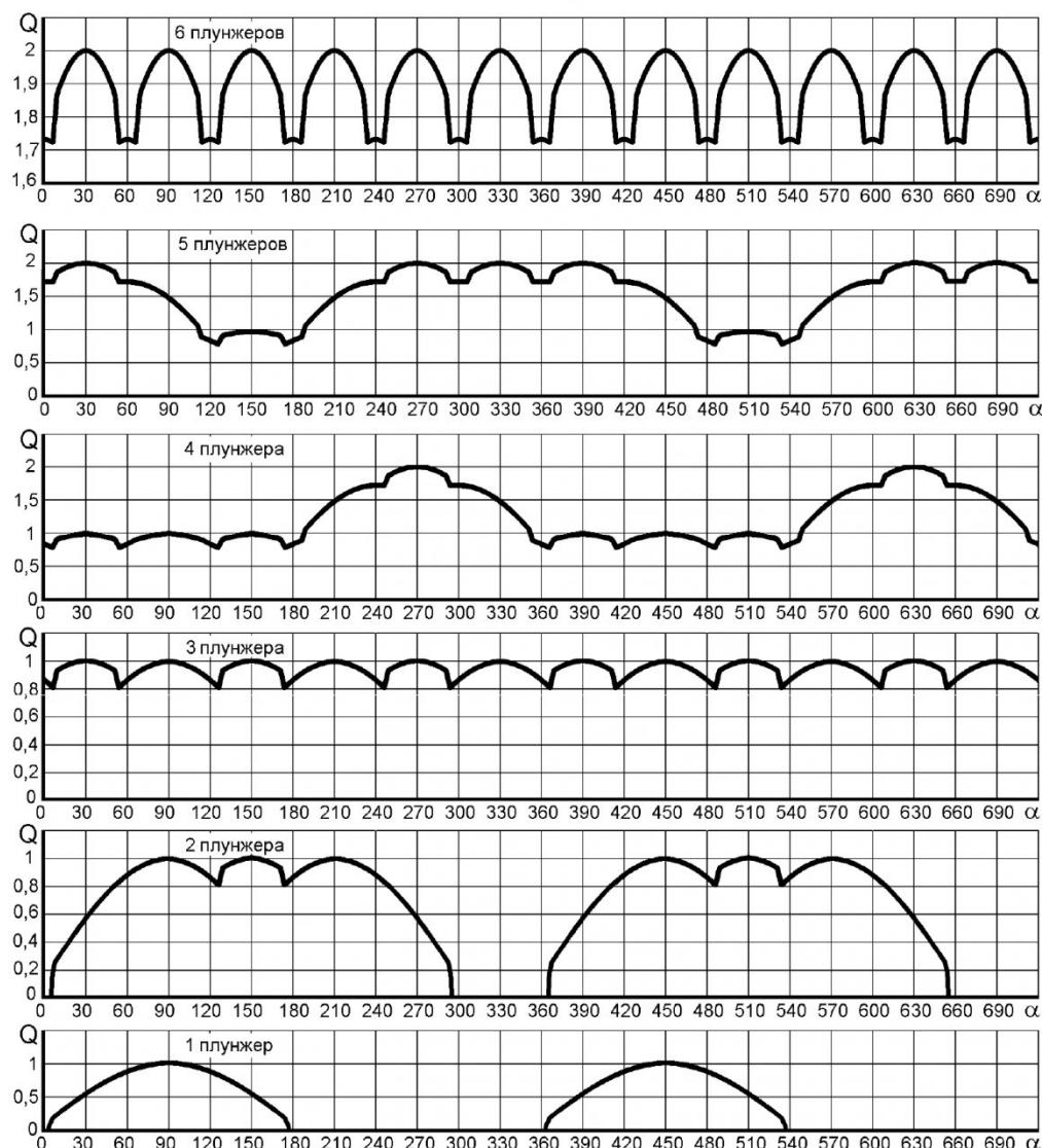
Графики подачи многопоточного насоса типа Н403 при уменьшении числа работающих плунжеров от шести до одного
