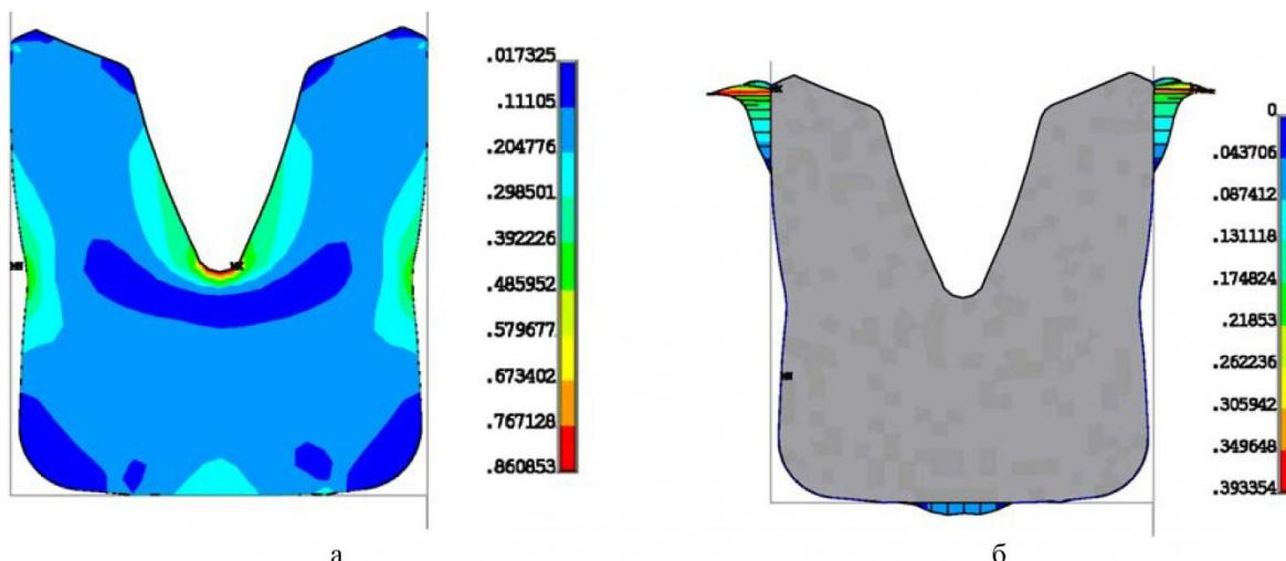
Рис. 3. Эквивалентные по Мизесу (а) и контактные (б) напряжения манжеты после сборки гидроцилиндра
