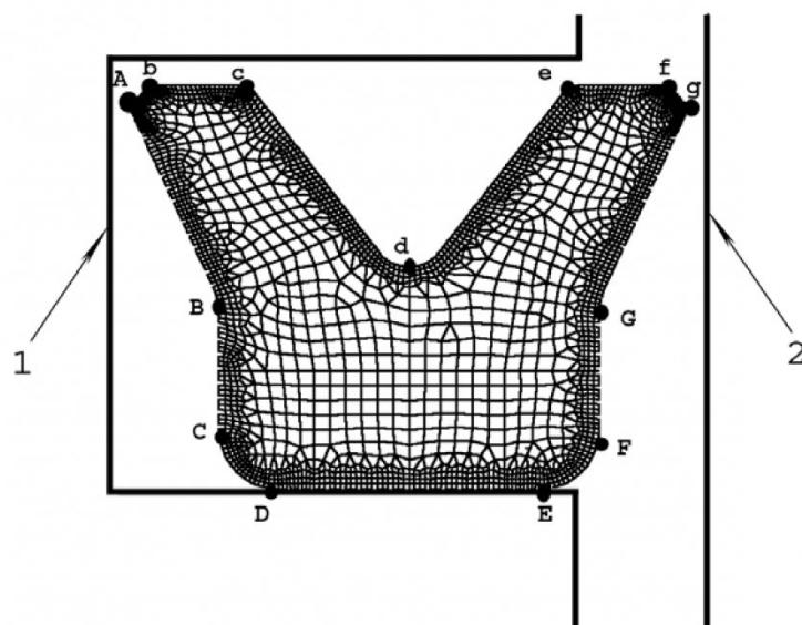
Рис. 2. Схема расположения манжеты перед началом расчёта:
