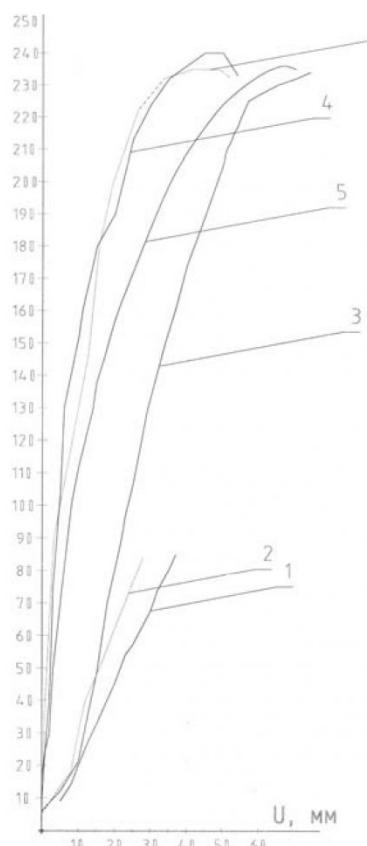
Рис. 4. Нагрузочные характеристики канатных анкеров, закрепленных минеральными композициями
