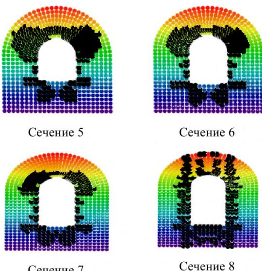
Рис. 4. Зоны нарушения сплошности в различных сечениях сопряжения (см. рис. 2)
