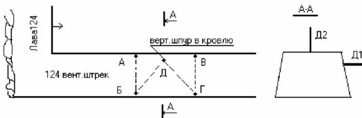
Рис. 2. Схема расположения измерительной станции
