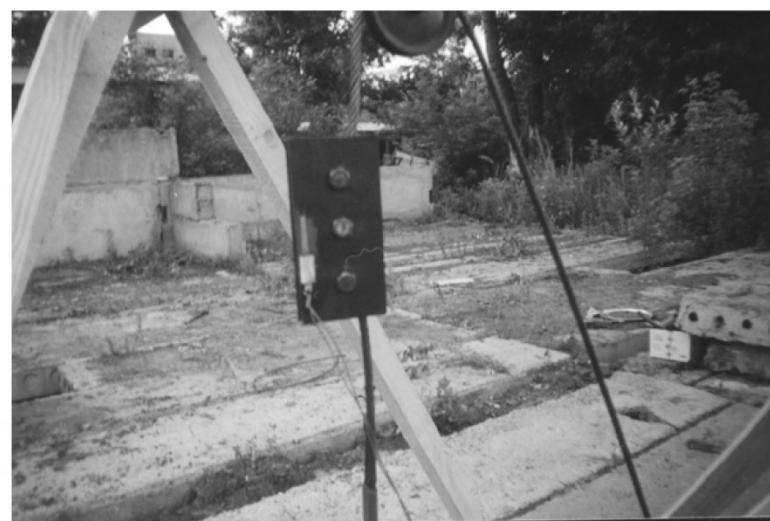
Рис. 2. Устройство для измерения усилий в канате
