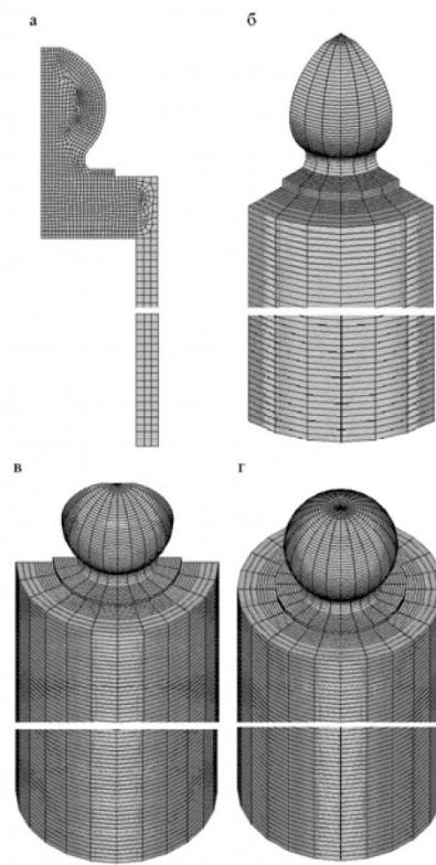
Рис. 2. Разбиение на конечные элементы моделей: а) 2D осесимметричной; б) 3D четверти; в) 3D половины; г) 3D полной
