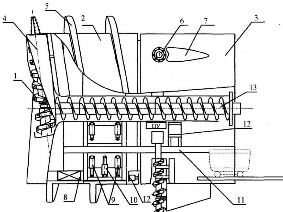
Конструктивная схема ВПА ЭЛАНГ самолетной компоновки
