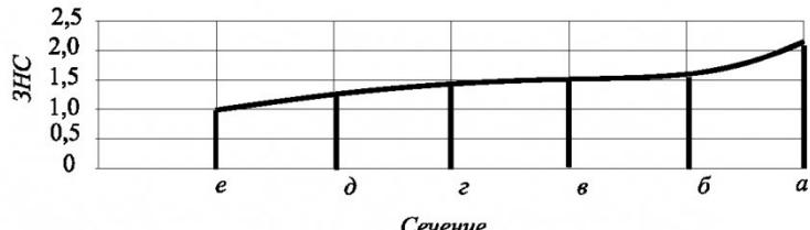
Рис. 3. Изменение вертикального размера зоны нарушения сплошности по длине тоннелей (рис. 1)
