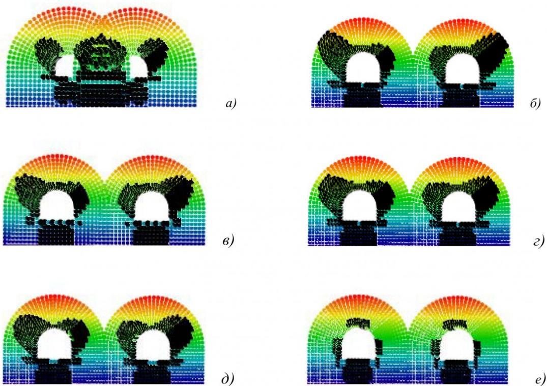
Рис. 2. Зоны нарушения сплошности в разных сечениях тоннелей (рис. 1)
