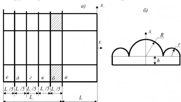
Рис. 1. Схема сопряжения станции и тоннелей (а - заштрихованная область усиленного проявления горного давления, б - сечение трёхсводчатой станции)
