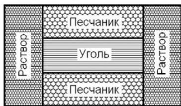
Рис.1. Схема образца с чередующимися структурами №1
