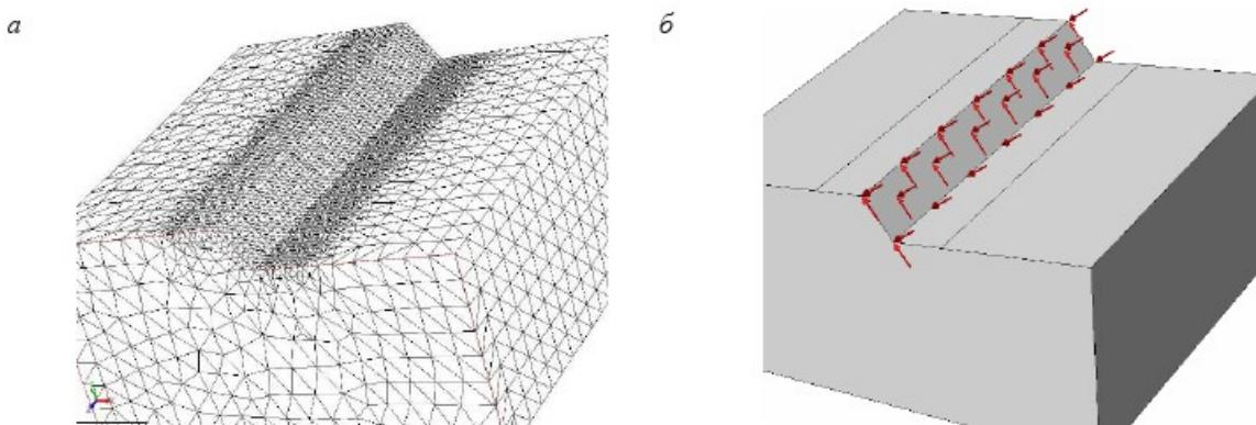
*Рис. 2. Схема приложения нагрузки к модели уступа
