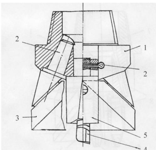
Рис. 2. Комбинированное долото с шарошечными лапами с коническими хвостовиками
