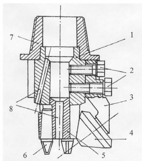
*Rис. 1. Комбинированное долото со съемными шарошечными лапами, соединенными с корпусом долота*
