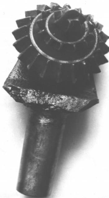
Рис. 3. Шарошечная лата с круглым хвостовиком
