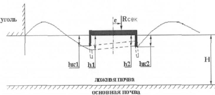
*Рис. I. Параметры продольной модели*
