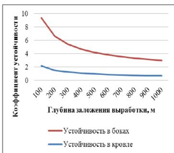
Рис. 1. Устойчивость на Абаканском руднике в железной руде (а) и песчанике (б)
