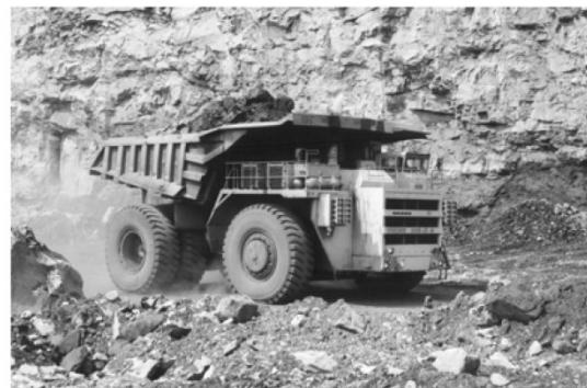
Рис. 15. Транспортировка добываемого топлива углевозом БелАЗ 7521 на разрезе "Сибиргинский"
