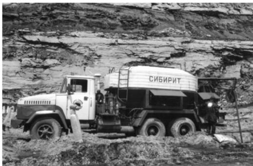
Рис. 12. Зарядная машина для "Сибирита"
