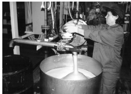
Рис. 10. Загрузка готового "Сибирита" в транспортный трубопровод
