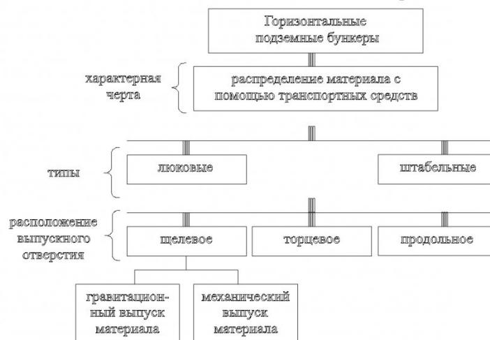
Рис.3. Классификация горизонтальных подземных бункеров
