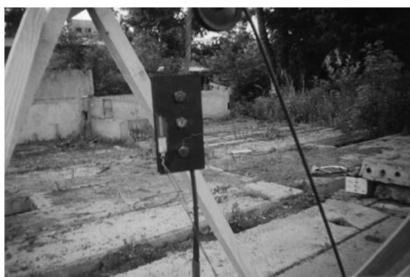
Рис.2. Устройство для измерения усилий в канатах
