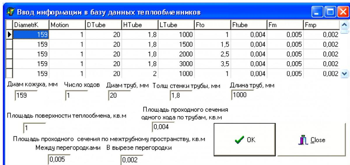
Рис.2. Панель программы добавления размеров теплообменников
