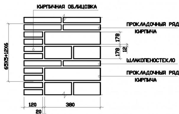
Рис. 2.2. Стеновые ограждения из шлакопеностекла с кирпичной кладкой с жёсткими связями
