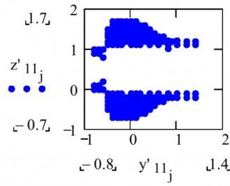
Рис. 7. Зона нарушения сплошности в сечении, совпадающем с продольной плоскостью боковой выработки
