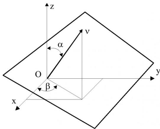
Рис. 2. Положение поверхности ослабления в пространстве
