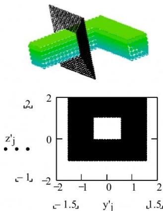
Рис. 3. Произвольная плоскость, перпендикулярная оси выработки (слева) и её проекция на координатную плоскость  $y'z$  (справа)
