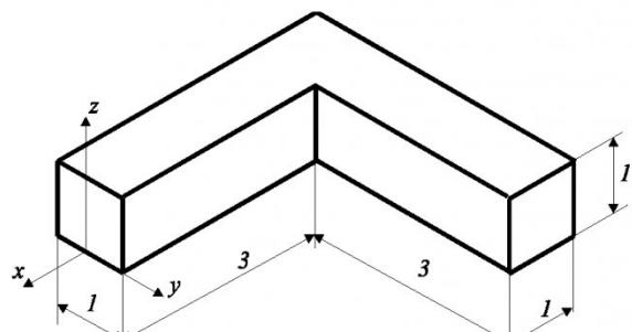
Рис. 1. Сопряжение двух выработок квадратного поперечного сечения
