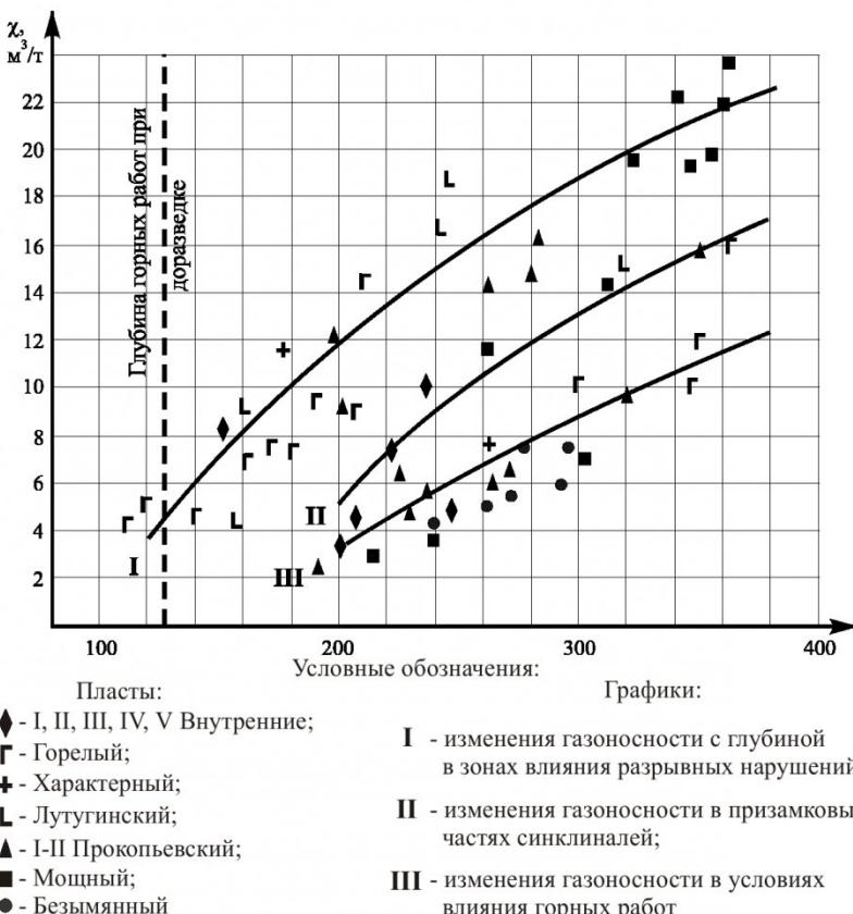
*Рис.1. Графики изменения газоносности  $\chi$  с глубиной в метановой зоне на горном отводе разреза "Бачатский" (Кузбасс)*
