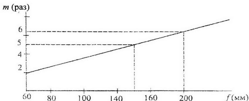
Рис. 4. График зависимости коэффициента «*m*» от стрелы прогиба затяжки
