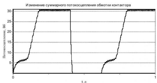
Рис. 5 - Потокосцепление обмотки
