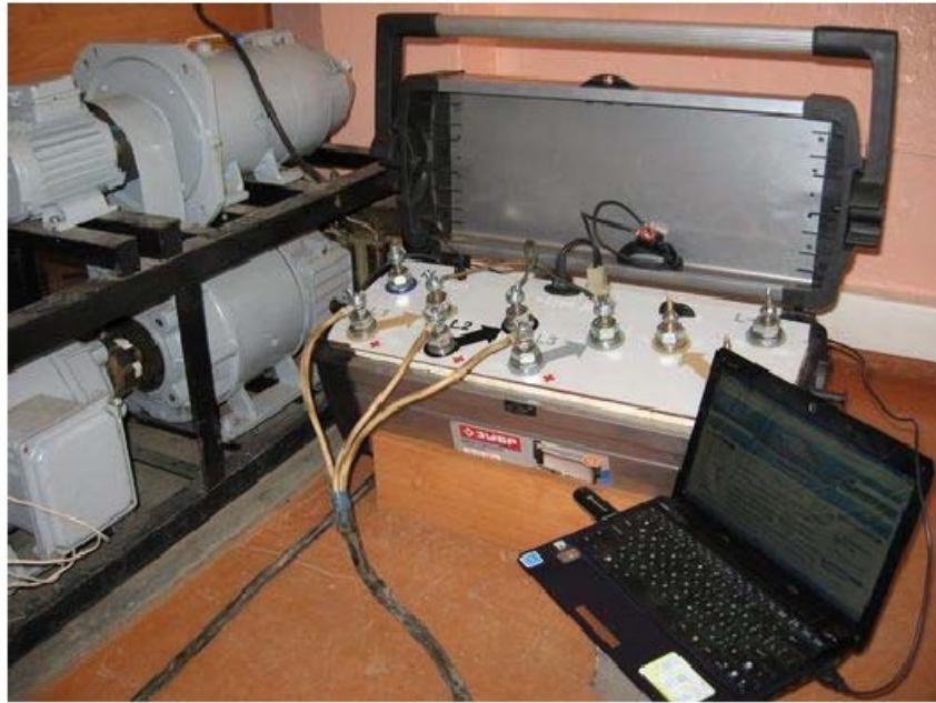
Рис. 2. Внешний вид мобильного испытательного стенда
