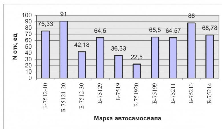
Рис. 1. Распределение отказов на среднесписочный автомобиль
