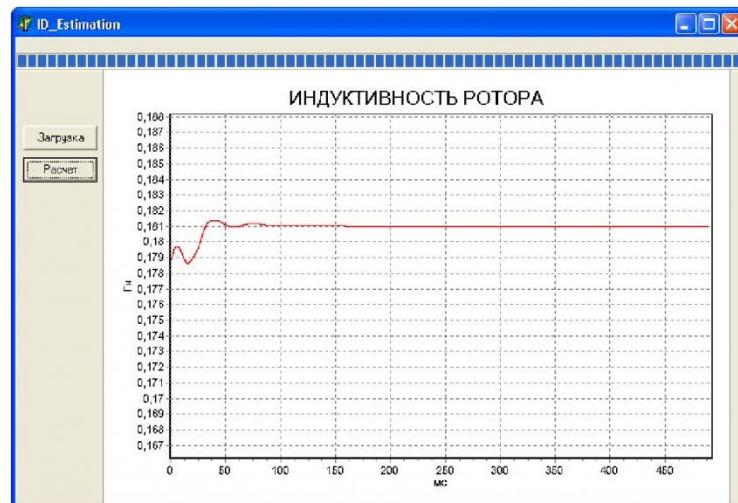
Рис.2. Процесс определения индуктивности ротора двигателя 4AX90L4Y3
