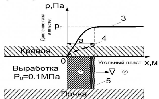
Рис.1. Распределение газового давления впереди забоя подготовительной выработки
