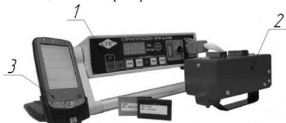
Рис. 2. Структуроскоп магнитный КРМ-Ц-К2М
