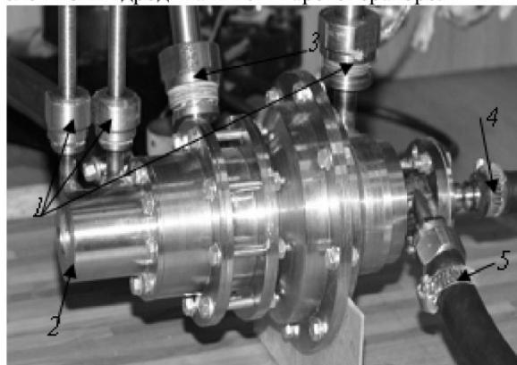
Рис. 4. Водород-кислородный пароперегреватель:
