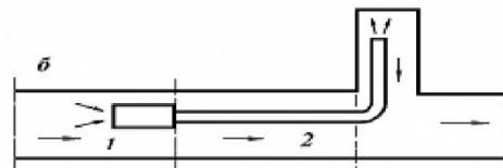
Рис. 1. Схемы установки ВМП
