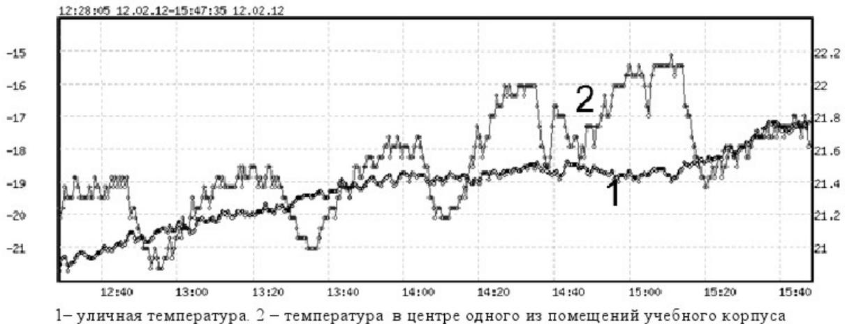
Рис. 4. Температурный мониторинг здания
