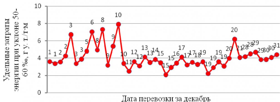
Рис. 3. График удельных затрат энергии автосамосвала БелАЗ-75131 №1345 при уклоне 50-60%
