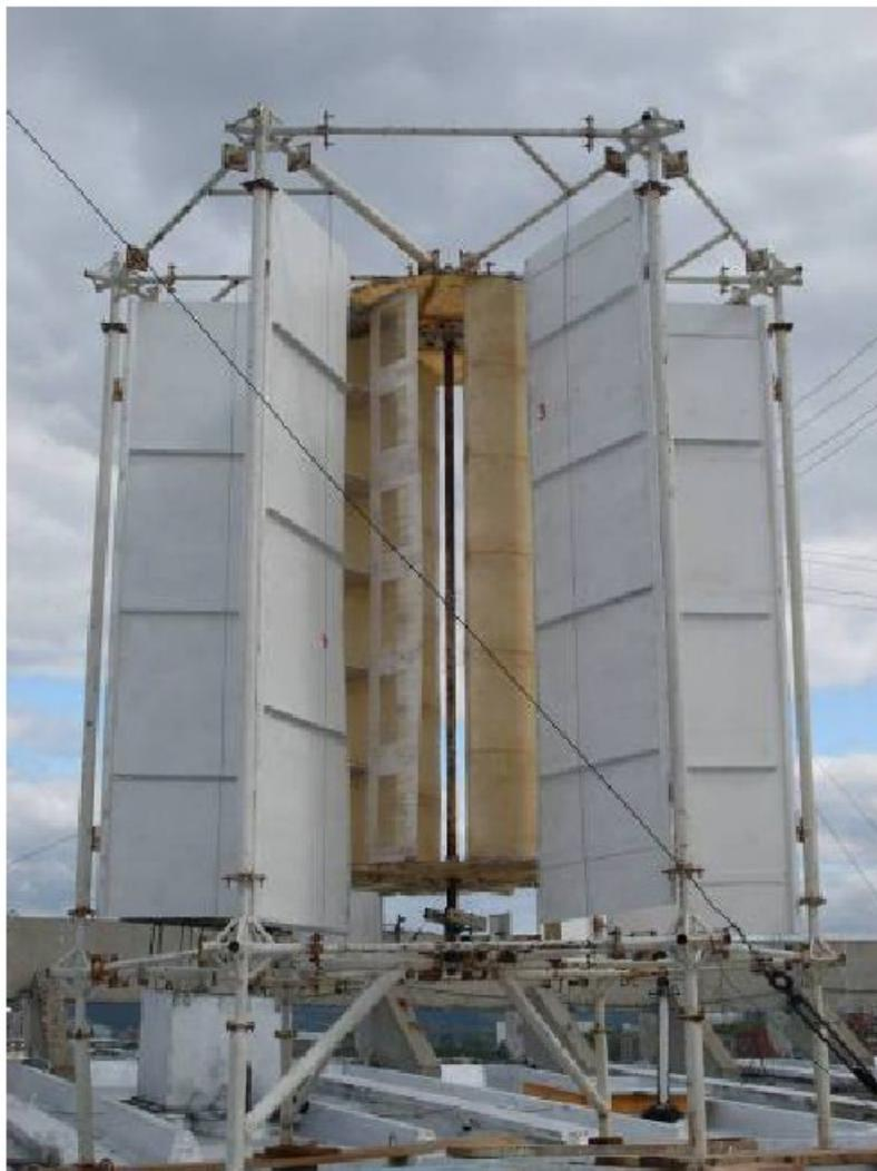
*Рис. 1. Общий вид экспериментальной установки с тремя лопастями типа «Колокол» на крыше жилого дома*
