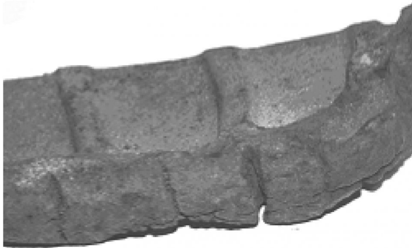
Рис. 1. Поверхностное окисление и растрескивание колосников в процессе эксплуатации
