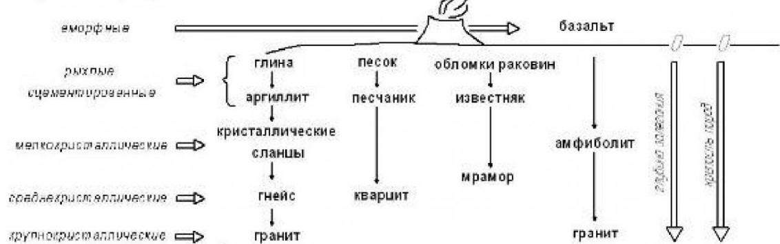
Рис. 5 . Разрез видимой части литосферы
