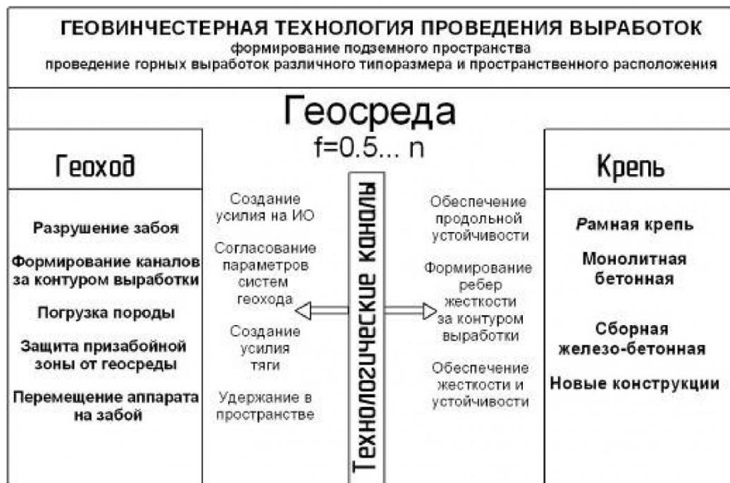
Рис. 2 . Структура геовинчестерной технологии проведения горных выработок
