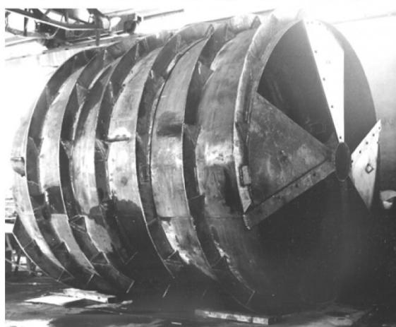
Рис. 3 . Экспериментальный образец геохода ЭЛАНГ-3 диаметром 3м
