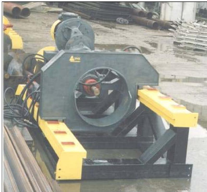
Рис. 5. Бурошнековая машина конструкции КузГТУ
