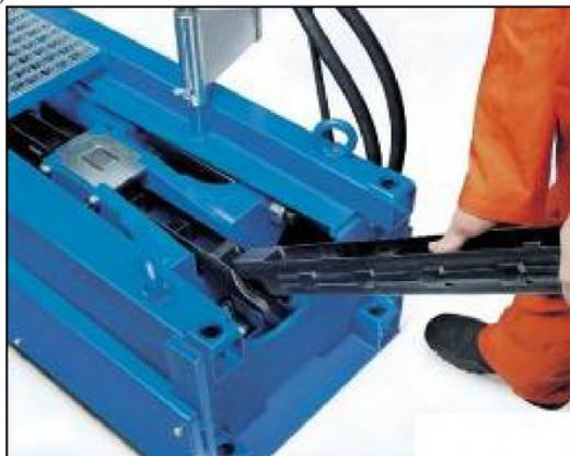
*Рис. 2. Сборка буровых штанг по технологии Quicklock*
