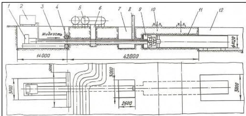
*Рис.6. Схема проведения горизонтальной скважины для газопровода в г.Новокузнецке: 1-бурошнековая установка; 2-емкость в жидкостью; 3-рабочий котлован; 4-якорь; 5-теплотрасса; 6-бетонная опора; 7-промежуточный котлован; 8-свая; 9-расширитель обратного хода; 10-железнодорожный путь; 11-коужух; 12-приемный котлован*
