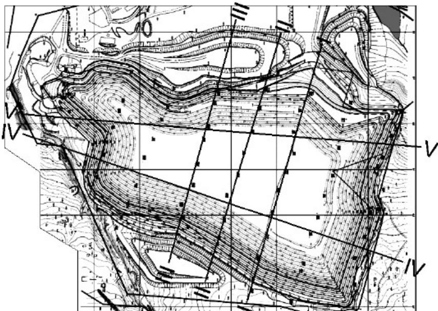
*Рис.1. План карьера известняков и расположение расчетных сечений I–V*
