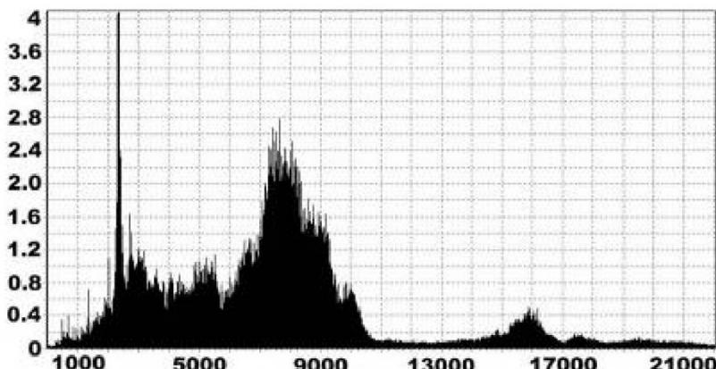
Рис. 5. Частота вибросигнала при обработке незакаленных сталей
