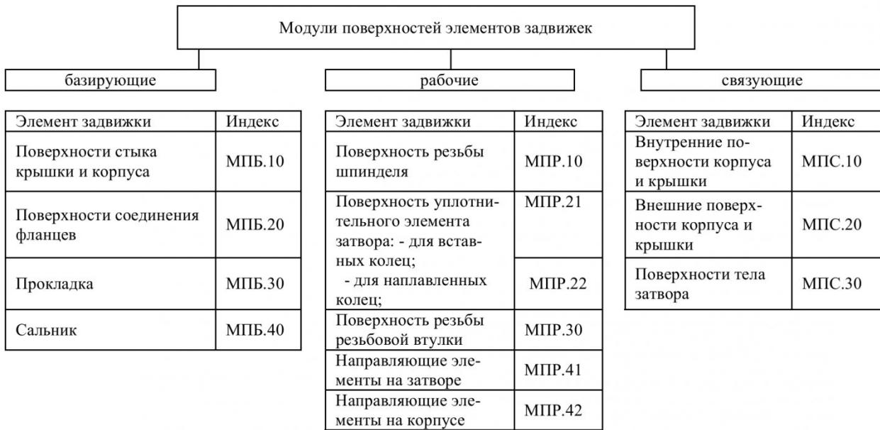
Рис. 2. Блок-схема индексов элементов задвижек
